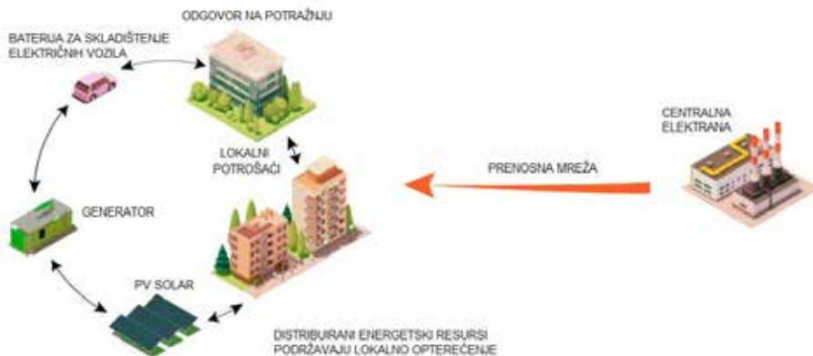
Slika 1. Generatori za proizvodnju električne energije kao distribuirani energetske resursi
